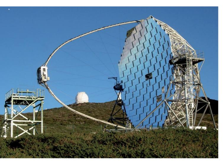
Sono dei giganti che stando sulla Terra vanno alla ricerca dei messaggeri della materia oscura provenienti dallo Spazio, e usano degli specchi come strumenti per catturarli: sono i telescopi gamma di tipo Cherenkov.
