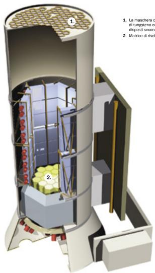
1. La maschera codificata: una piastra di tungsteno con una matrice di fori disposti secondo uno schema definito.
