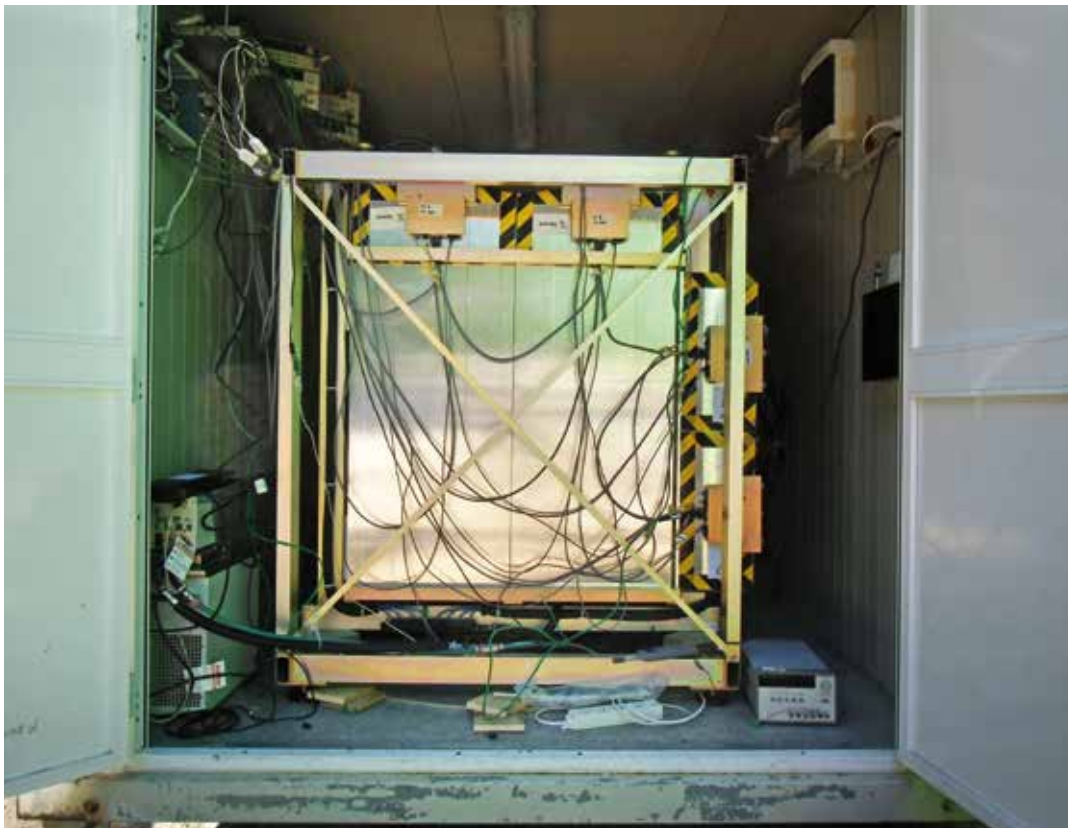
a. Lo strumento con cui nell'aprile 2013 è stata fatta una presa dati dimostrativa sul Vesuvio, il prototipo Mu-Ray sviluppato dall'Infn. Il rivelatore di muoni è formato da 384 scintillatori plastici letti da fotomoltiplicatori al silicio. Il consumo dell'intero apparato è sufficientemente basso da funzionare senza essere connesso alla rete elettrica. All'interno del progetto premiale Infn-Ingv Muraves entro il 2017 è prevista l'installazione sul Vesuvio di tre rivelatori con quattro piani traccianti da 1 m 2 ciascuno. I nuovi rivelatori sono una versione migliorata del prototipo Mu-Ray.
