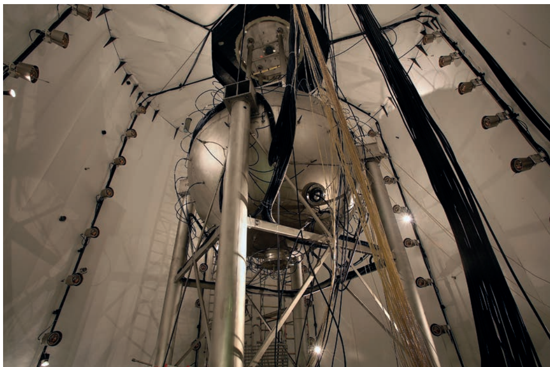
c. L'esperimento DarkSide-50, presso la sala C dei Lngs. L'immagine è scattata all'interno del serbatoio di acqua che serve da schermo per la radioattività ambientale e da rivelatore di muoni cosmici. La sfera centrale racchiude un ulteriore rivelatore a scintillazione liquido per riconoscere e scartare gli eventi prodotti dai neutroni generati nei materiali circostanti. La camera a proiezione temporale ad argon liquido/gassoso, non visibile in questa immagine, si trova all'interno della sfera immersa nello scintillatore.
