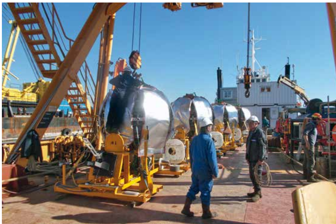
d. Quattro Detection Unit di Km3net pronte per essere deposte sul fondo del Mediterraneo. Negli abissi marini, dove migliaia di metri d'acqua schermano i raggi cosmici, cercheranno neutrini provenienti dal cosmo o dall'alta atmosfera.
