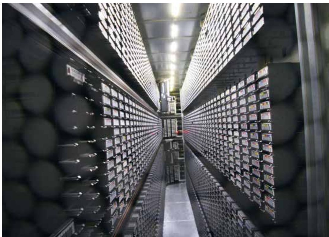
c. Il robot del Cnaf (una specie di silos orizzontale lungo 10 m e largo 2,5 m) che gestisce un archivio di 10.000 “ tape ”, dove sono memorizzati i dati di Lhc e dei principali esperimenti dell'Infn. Ogni tape (in italiano “nastro”) è una cassetta magnetica con dimensioni circa il doppio di quelle delle cassette che si utilizzavano molti anni fa per ascoltare musica.
