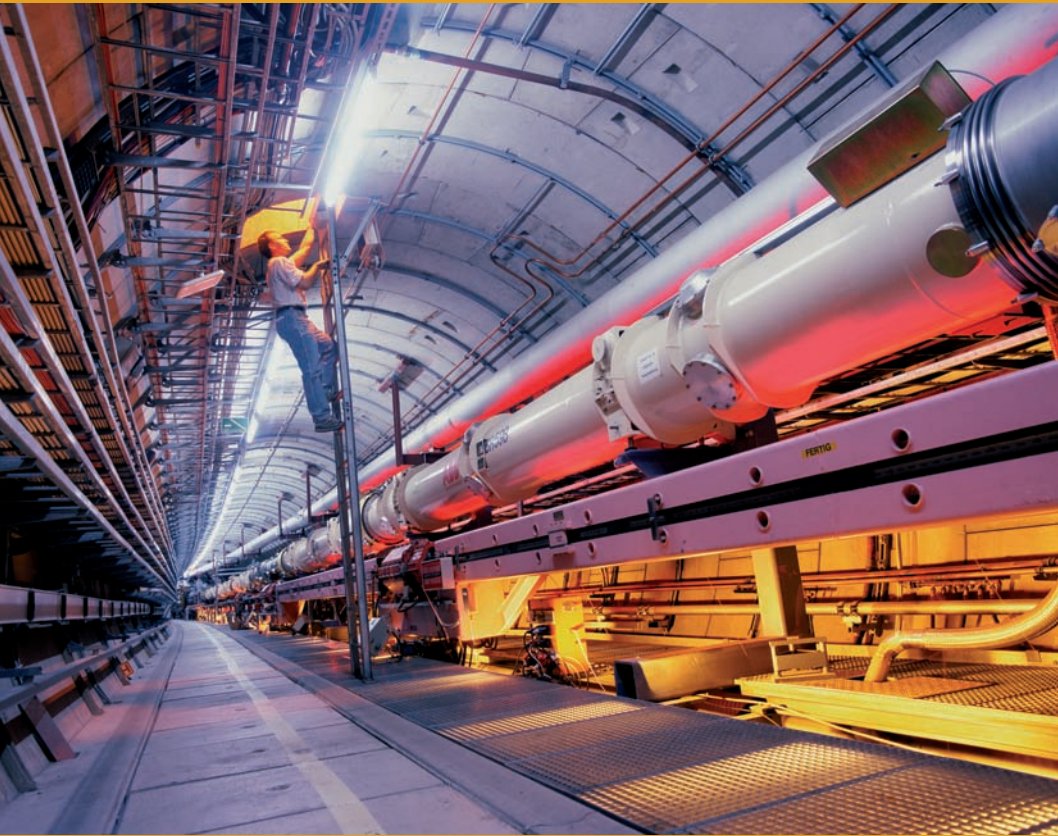
a. L'acceleratore Hera del laboratorio Desy di Amburgo: un anello con una circonferenza di 6,3 km capace di far collidere protoni con elettroni per esplorare la struttura dei protoni fino a scale di dimensioni di 10^{-15} mm (un milionesimo di miliardesimo di mm).
